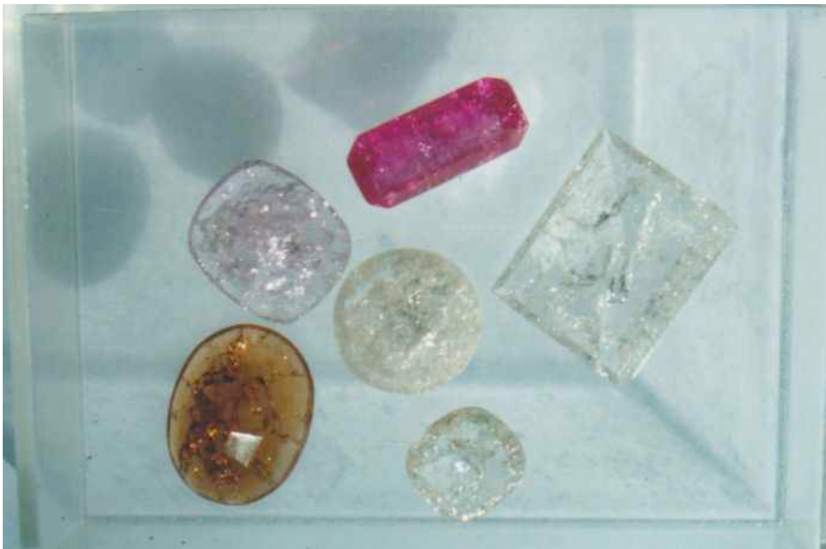
Abb. 9: Auch Steine einer Härte 7 und 8 zeigen Risse.
